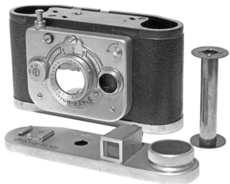
写真 19 リッチレイ-6の軍艦部を取り外し、プレッシャープレート(写っていない)を抜いて、フィルムを装填する。Z光軸構造は頑丈なベークライト製のボディに守られていて、どうしても見る事はできなかった。
