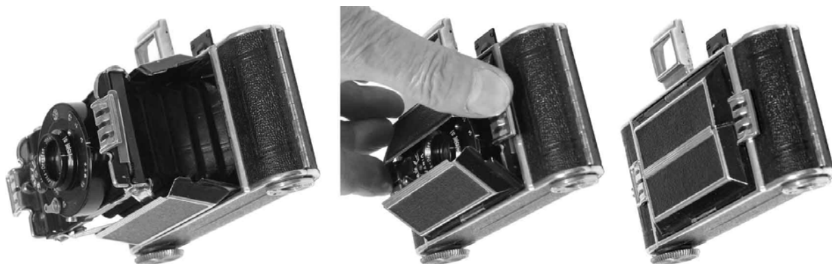
写真6 バルダ ピエレットの半自動の折り畳み方法。押し込んで行くとまず向こう側が閉じ、次いでこちら側が開まる。
